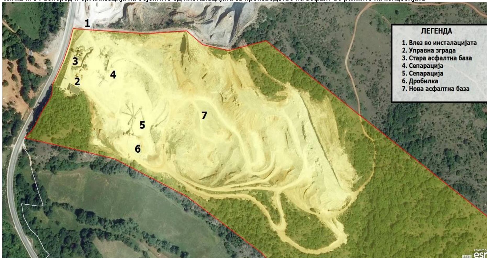
Слика II. 3 Распоред и организација на објектите од инсталацијата за производство на асфалт во рамките на концесијата
